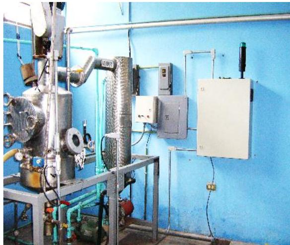
Figure 2: Evaporador-cristalizador escala planta piloto.
